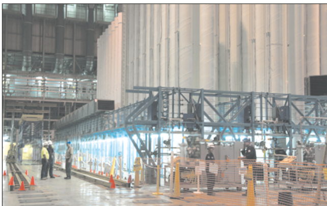
Демонстрационный каскад американских центрифуг типа AC100
