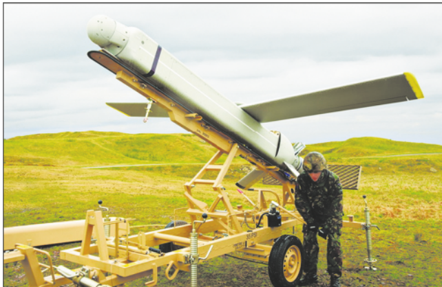
Беспилотный летательный аппарат «Файр Шэдоу» и подготовка его к запуску с катапульты
